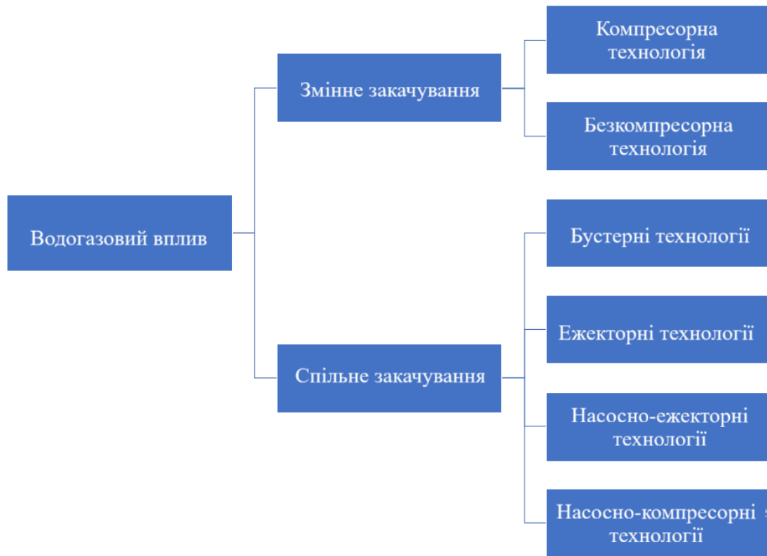
Рис. 2.8 - Класифікація технологій водогазового впливу
