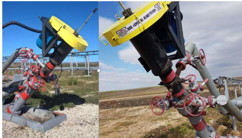
Рис. 2.13 Гирло свердловини при видобутку рідини за допомогою ГШНУ з наземним приводом
