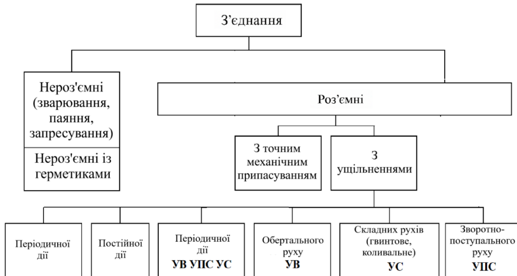
Рис. 2.11 - Типи герметизованих з'єднань та індексація ущільнень
