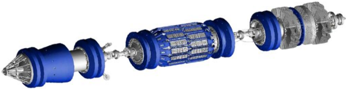
Рис. 2.9 Загальний вигляд внутрішньотрубного інспекційного комбінованого магнітно-ультразвукового дефектоскопа
