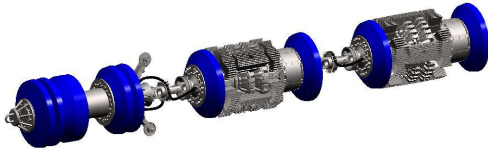
Рис. 2.8 Загальний вигляд внутрішньотрубного інспекційного приладу типу TFI
