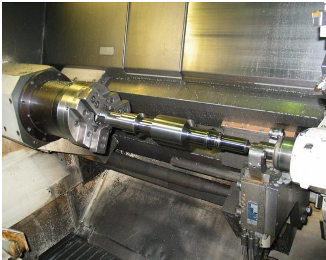
Рис. 3.2. Процес механічної обробки на токарно – фрезерному верстаті VD16M
